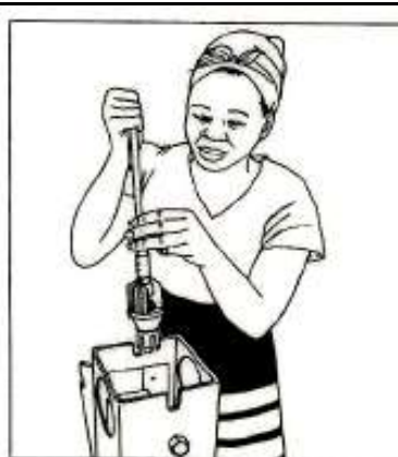
14. Remove the plunger
